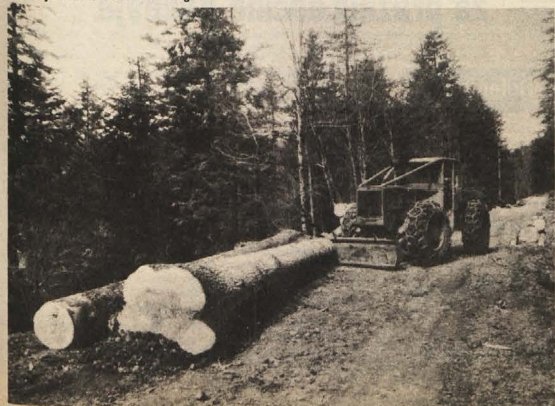
Spravilo hlodov ob kamionski cesti z zgibnim traktorjem
