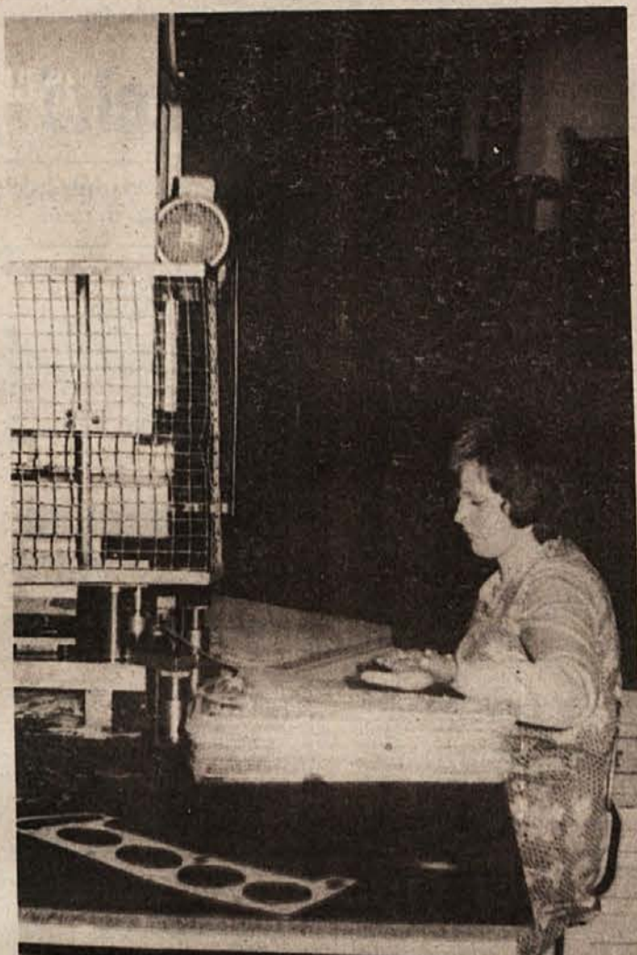
Izdelava tesnila glave motorja za VAZ „LADA”
