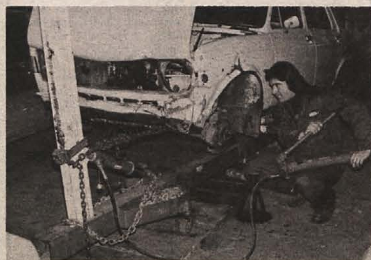
Ravnanje poškodovane karoserije z raztežno hidravlično napravo.
