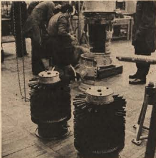
Montaža kompresorskih turbin v ohišje motorja je eno najzahtevnejših opravil
