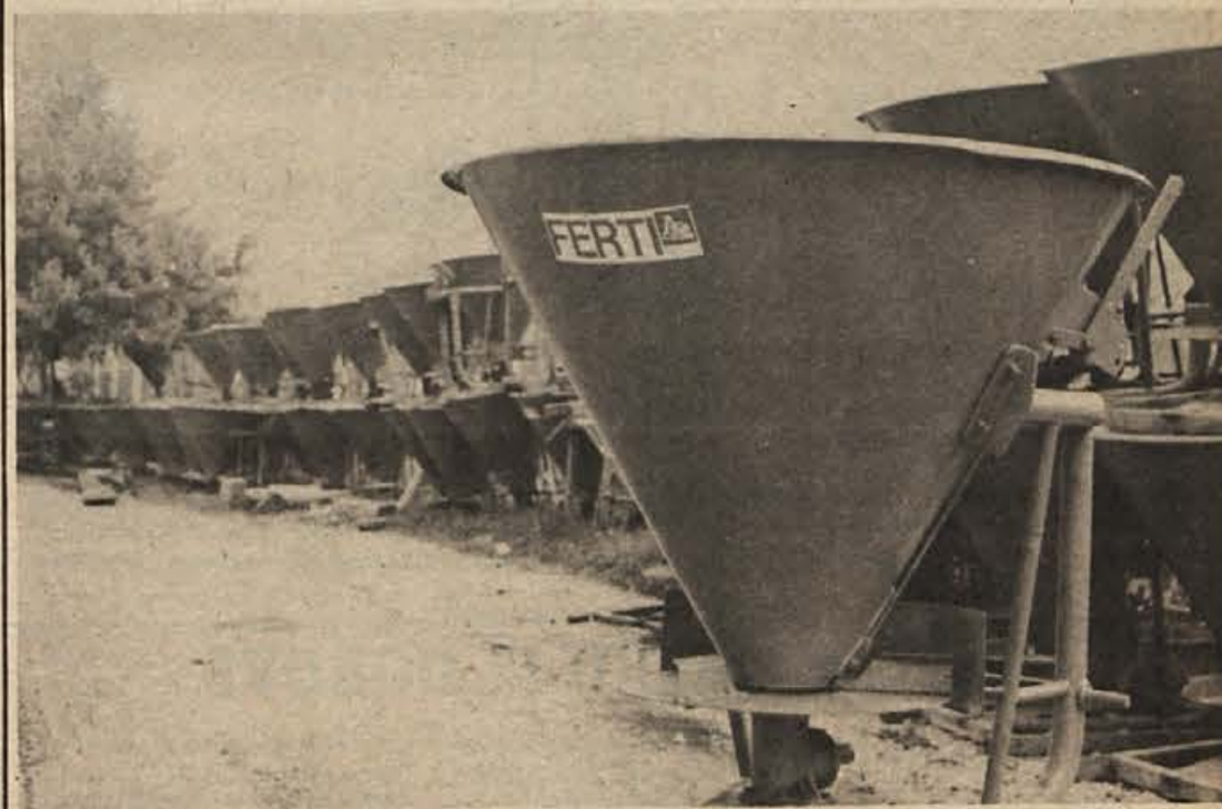
V novem brežiškem obratu AGROTEHNIKE izdelujejo serijsko kmetijsko mehanizacijo. Na sliki vidimo posipalnik za umetna gnojila. (Foto: M. Vesel)
