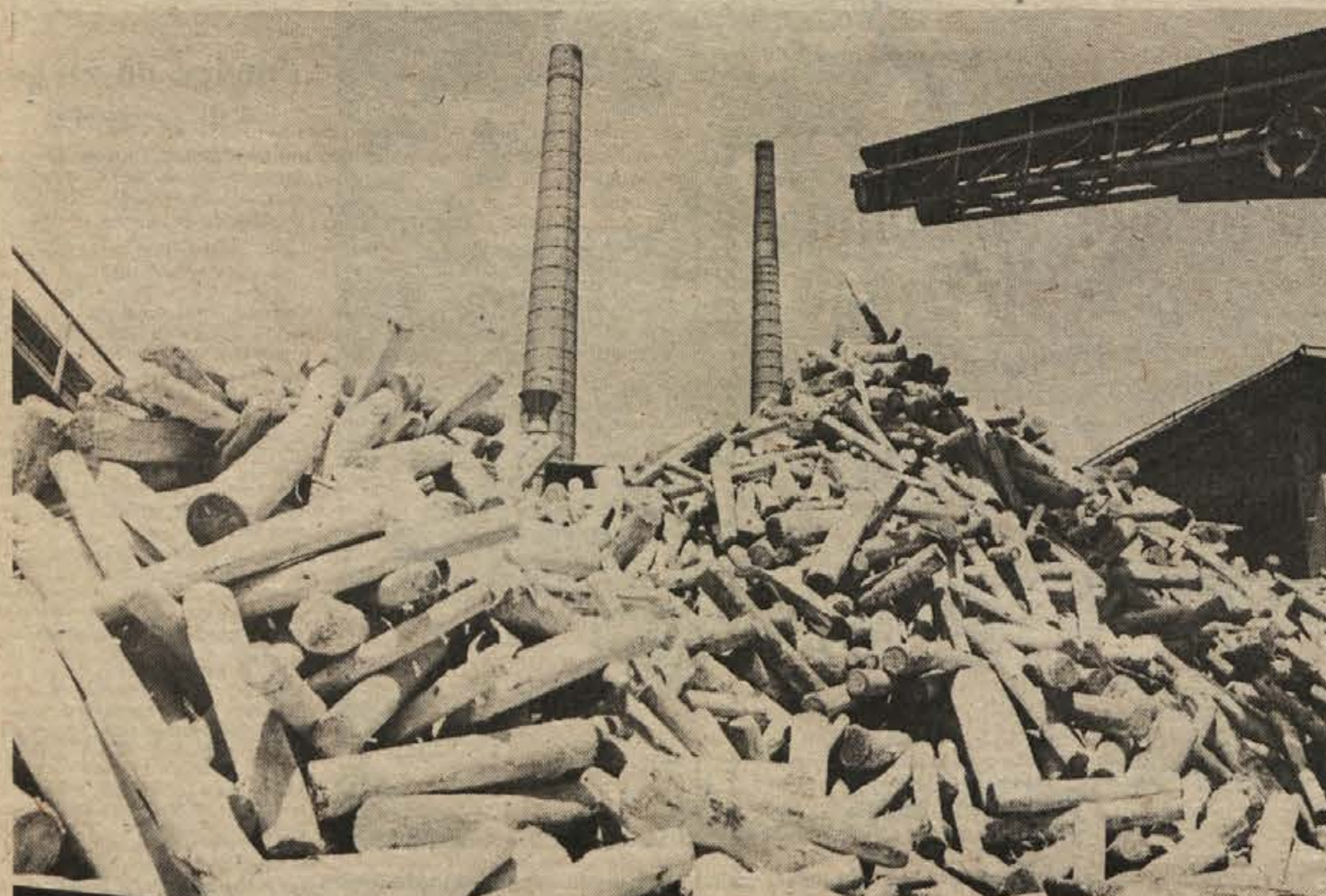
Brez lesa bi tovarna obstala. Zato posvečajo nabavi te surovine največjo pozornost. Na sliki: gomila v čistilnem bobnu oluščanih polen.
