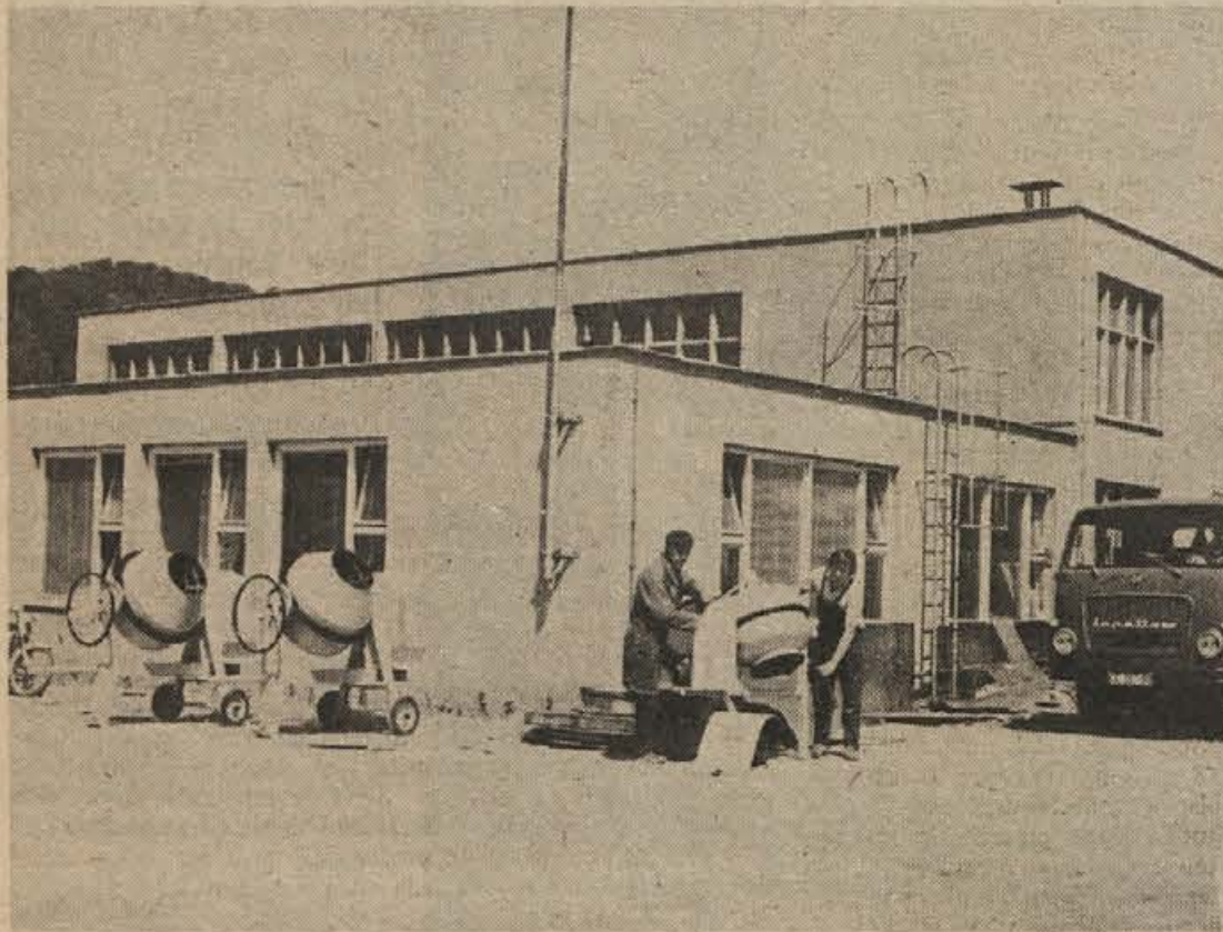
V novih delavniških prostorih v Brestanici izdelujejo 100 in 250-litrne betonske mešalnike ter hidrofore. Tovrstni izdelki gredo dobro v denar.
