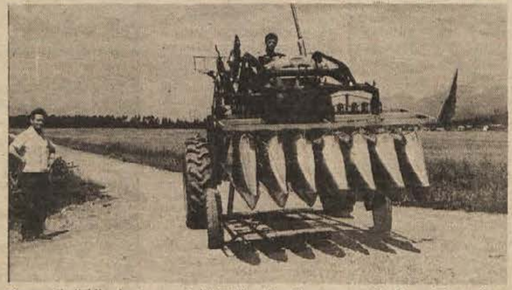
Po naročilu ljubljanske tovarne „Lek“ je Viktor izumil napravo za obiranje rženih rožičkov.
