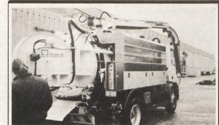
NOVO SPECIALNO VOZILO - Ena od dveh novih specifičnih vozil novomeške Komunale, namenjeno za čiščenje kanalizacije ter praznjenje in čiščenje greznic.
